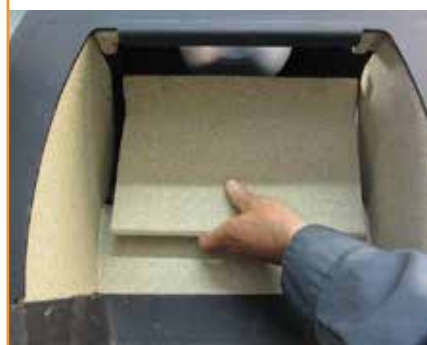
Øverste hvelv settes inn med utskjæring opp 15
