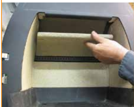
La platen støtte på skinne med luftehull 19
